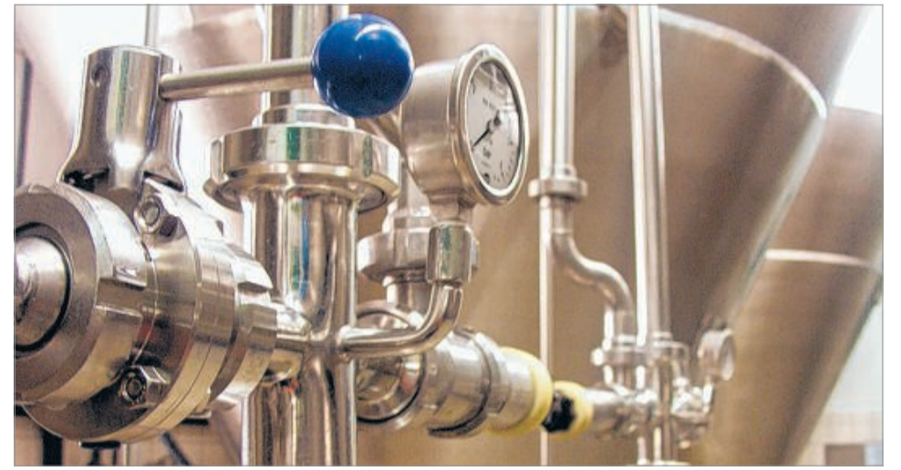
In riesigen Tanks wird das Bosch-Bier bei einer Temperatur zwischen acht und elf Grad Celsius gegoren. Fotos: vg
