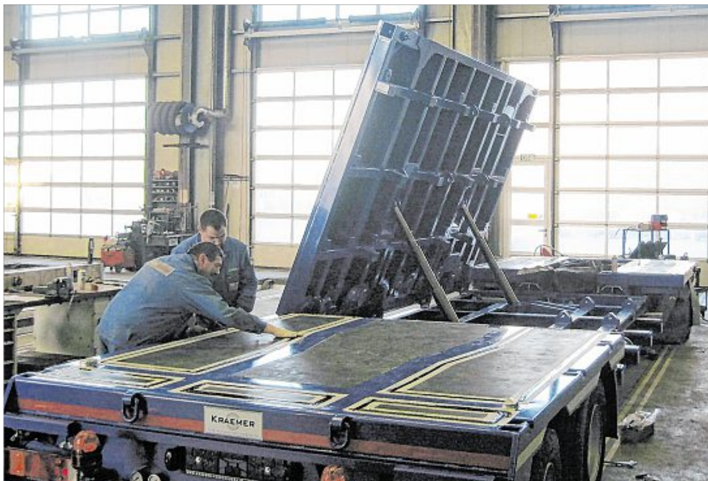
Das Unternehmen Kraemer Fahrzeugbau entwirft Lösungen für Spezialfahrzeuge. Hier zu sehen ist ein Schräglade-Anhänger für den Transport von Großkomponenten und Maschinenteilen. Fotos: Unternehmen (4)/Björn Weyand (1)
