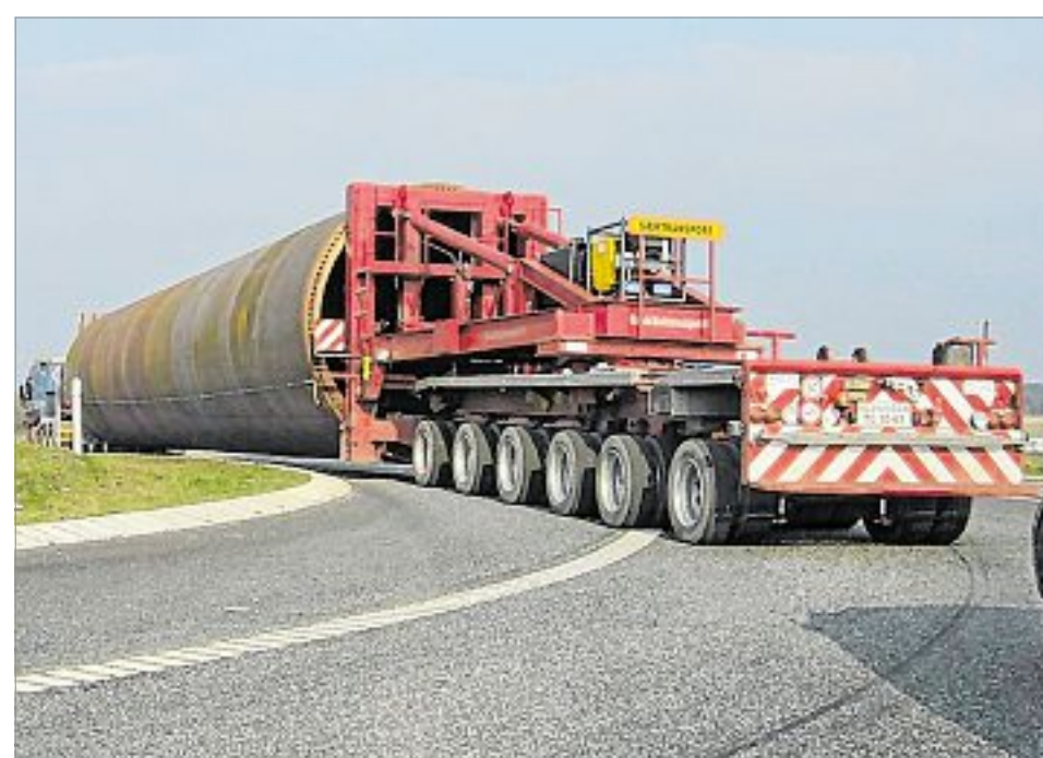
Kraemer Fahrzeugbau entwickelte auch diesen SNLL60 Selbstlenknachläufer mit hydraulischem Fahrwerk für den Turmtransport von Windkraft-Anlagen.
