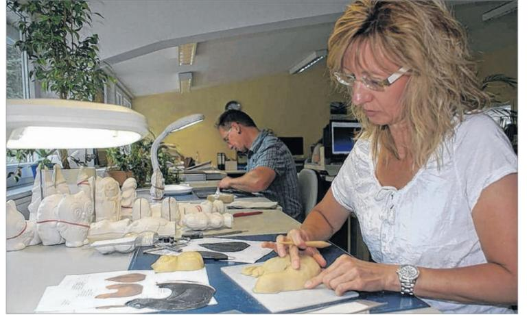
Die Entwicklung einer Form ist sehr viel aufwändiger als deren Herstellung im Spritzgussverfahren. Das fertige Produkt (mittleres Bild) nimmt seinen Anfang in der Modellentwicklung, die entweder digital (links) oder ganz althergebracht per Hand (rechts) erfolgt, stets in Zusammenarbeit mit und nach der Vorgabe des Auftraggebers. Fotos: Nicole Klappert
